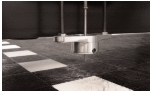
Vrták na tkaninu – až do průměru 9,5 mm (3/8“).
