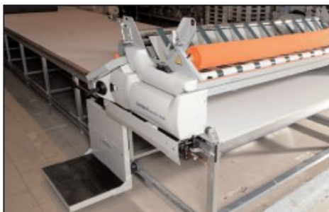
Nastavitelná základna umožňuje operátorovi pohyb podél stroje.
