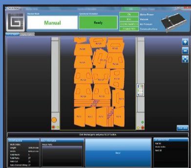
Volitelná pracovní stanice pro usnadnění identifikace a třídění dílů
