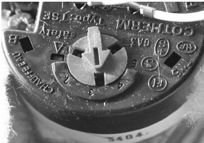
Detail regulačního termostatu
